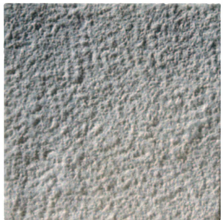
Fig. B.2.224 - Boccia medio a quattro denti.
