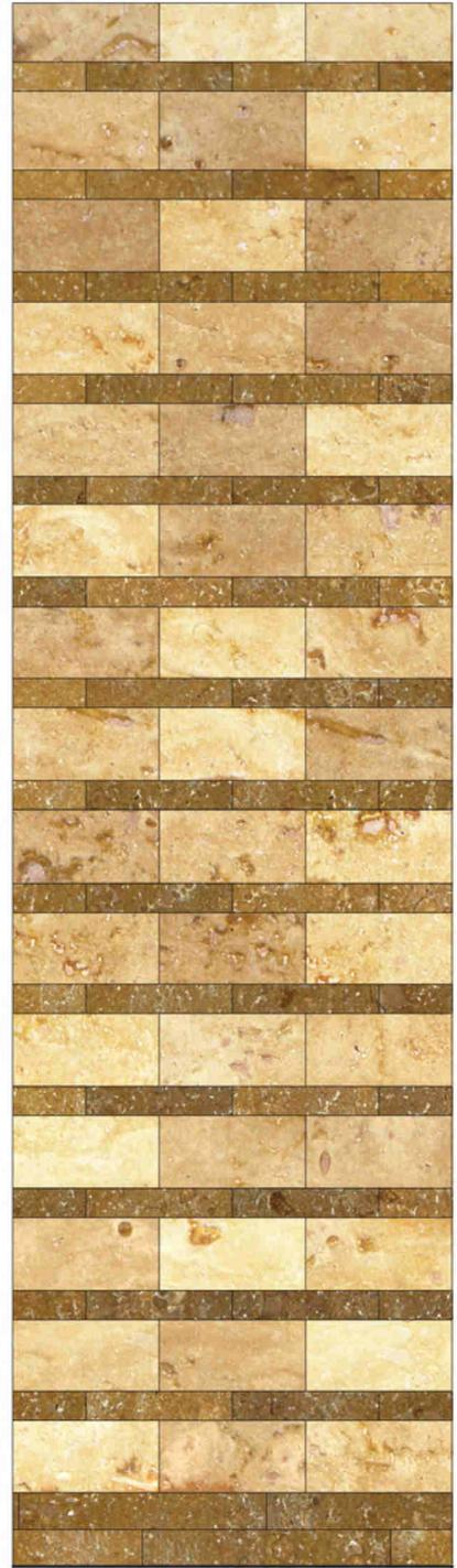
Rivestimenti sottili. Soluzioni compositive in funzione dei formati delle lastre e delle varietà del travertino. | pp. 170-171.
