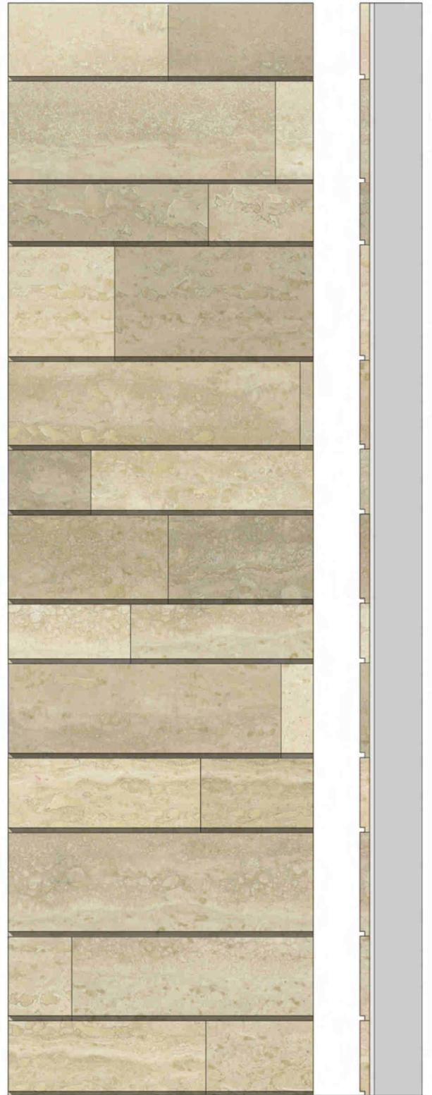
Rivestimento in lastre quadrate di travertino posato a secco; prospetto, sezione schematica e abaco delle diverse lavorazioni delle coste per il fissaggio degli agganci metallici. | p. 163.
