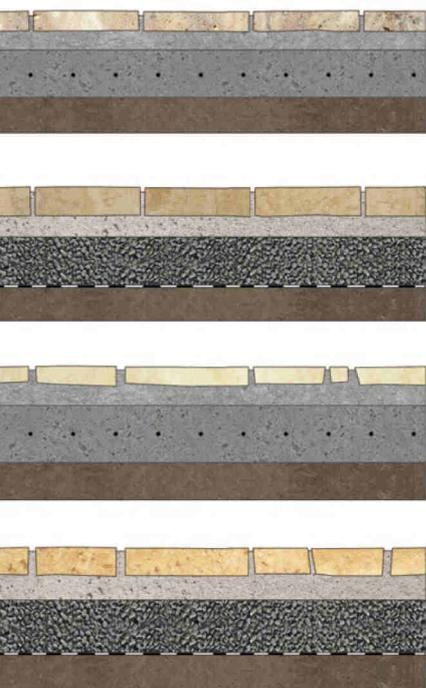
Sezioni tipo di pavimentazioni in lastre di travertino per esterni e per interni, posate con malta o su letto di sabbia.
